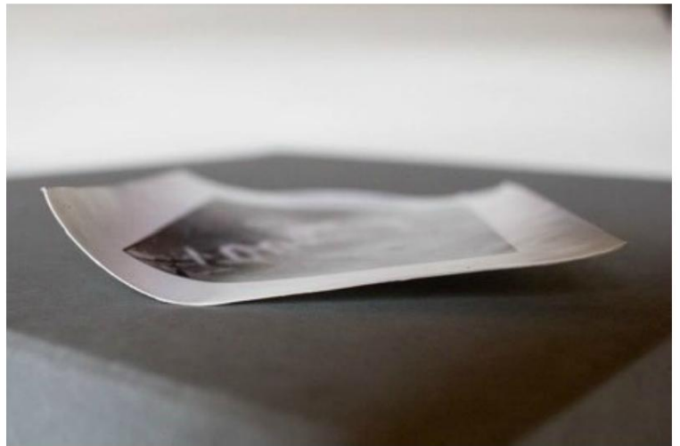
Un tirage sur papier FB gondole très facilement en séchant. Il est toujours possible de le relaver et de procéder à un séchage dans de bonnes conditions par la suite.
