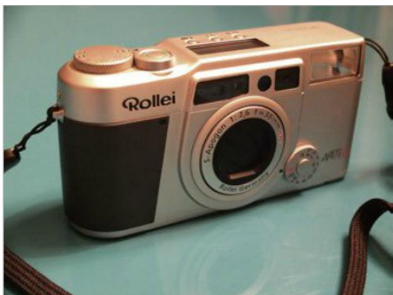
Le Rollei AFM offre un bel objectif lumineux à ouverture 2,6.
