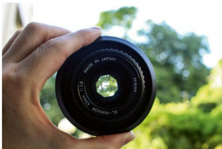
Nikon EL-Nikkor 63 mm, optique utilisée entre autres par le tireur de Salgado, fixée ici à la platine de l'agrandisseur.
