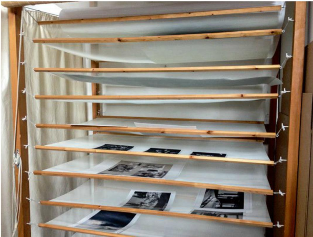
Séchage des épreuves sur claies avant d'être redressées à la presse à chaud
