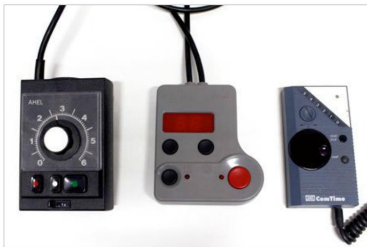
À gauche, un compte-pose électromécanique ; au centre, un modèle électronique de chez Durst ; et à droite, un autre modèle électronique de chez Jobo qui inclut une sonde pour calculer les temps d'exposition et choisir le type de filtres.
