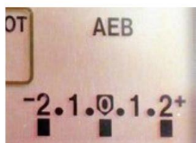
Programmation d'un bracketing sur un Canon EOS 5 avec un écart de 1 EV entre les vues
