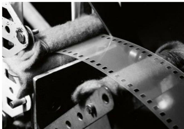
Dériveuse/coupeuse de films 135, fabrication artisanale © Lomig Perrotin
