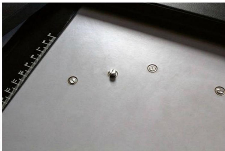
Vue du système de plots du margeur Ahel 3 lames
